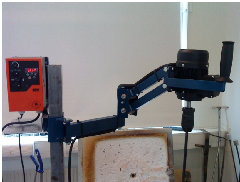
Figur 4.8 Närbild, färdig omrörningsenhet
