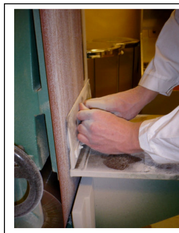
Bild 3. Planslipning av kilarna.
