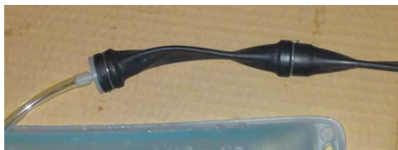
Bild 8, Gummislang utan vätsketryck
