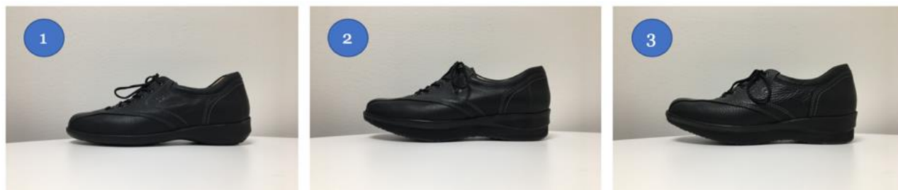
Figur 5. Bild på samtliga skor i sagittalplan med och utan rullsulor. 1). Bild på uR, skons vikt 341 gram. 2). Bild på fR, skons vikt 406 gram. 3). Bild på sR, skons vikt 455 gram.
